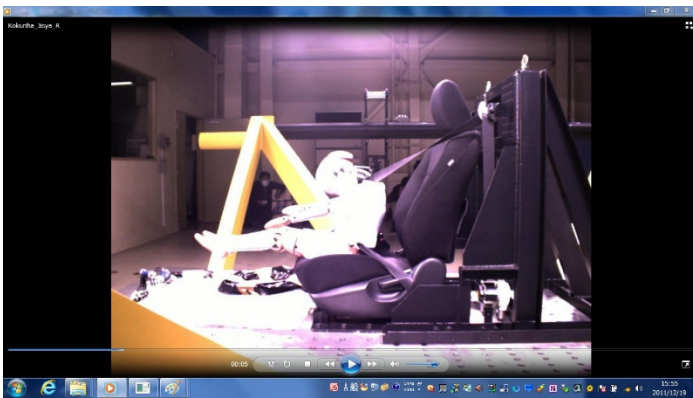
最大加速時（衝突時の模擬）でのダミーの状況
