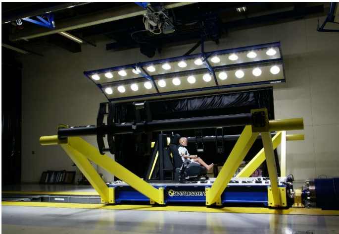
日本で行われた障害児用カーシートのスレッド試験（全体）
